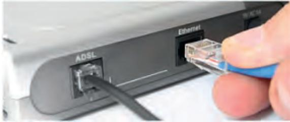
Figura 14.21: Conexión ADSL
