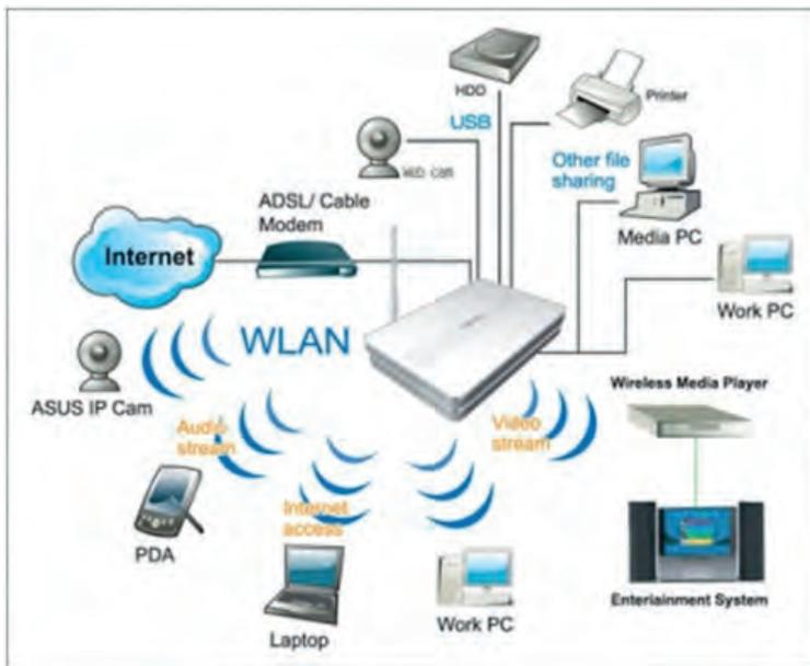
Figura 14.8: Representación de una Red WLAN
