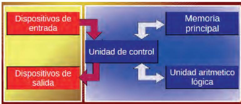
Figura 5.5: Esquema de los componentes del *hardware*.
