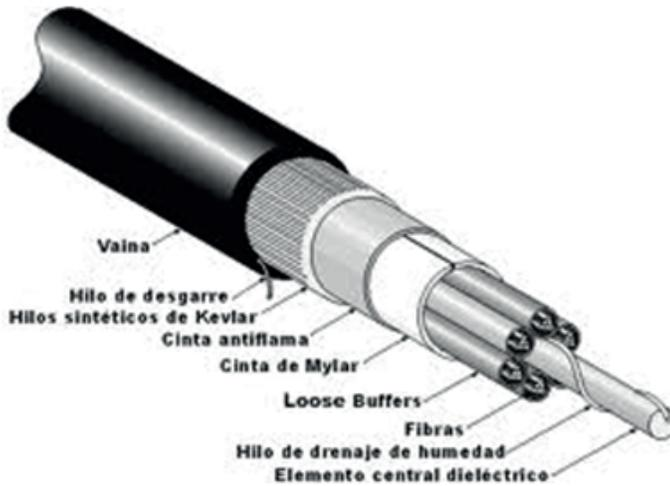
Figura 14.28: Cable de fibra óptica
