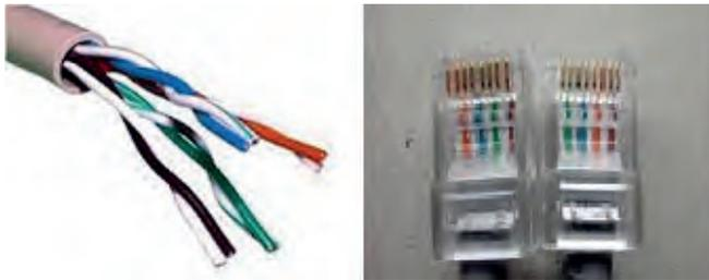
Figura 14.27: Cable y conector UTP
