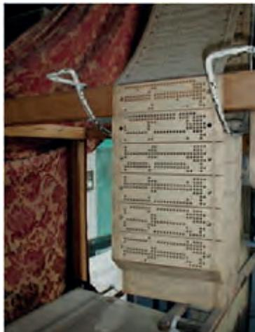
Figura 1.8: Máquina- telar de tarjeta perforada
